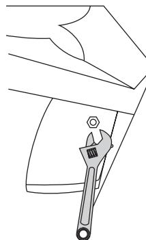
Stellen Sie nach dem Festziehen sicher, dass zwischen Gerät und Wand kein Spalt vorhanden ist. Wenn ja, verwenden Sie Dichtungsmittel, um die Lücke zu füllen.
