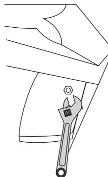
Après le serrage, assurez-vous qu'il n'y a pas d'espace entre l'appareil et le mur. Si c'est le cas, utilisez du mastic pour combler le vide.
